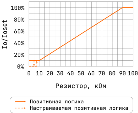
График диммирования при подключении внешнего резистора
